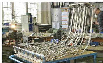
Abpäckvorrichtung für Dichtungseinlagen
