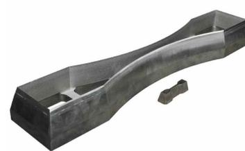
Stanzmesser zur Herstellung von Zerreißproben
