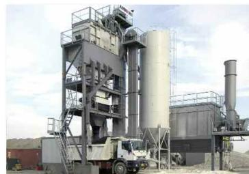
Eine Ammann JustBlack mit 120 Tonnen Stundenleistung im Irak
